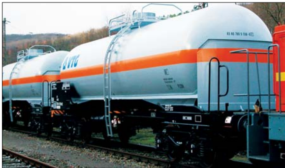
Crash Protected Rail Car von VTG, u.a. mit Schutzschilden vor den Tankböden
