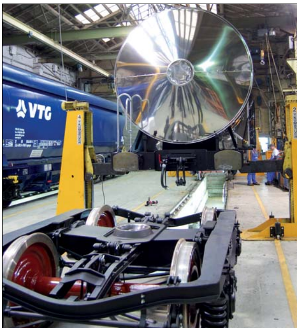
Ein Drehgestell mit verstärkten Radsätzen, die zudem einen neuen Korrosionsschutz (rot) bekamen, kurz vor der Montage unter einen VTG-Kesselwagen.
